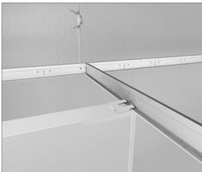
Rockfon Universal Baffle correttamente fissato a un profilo Chicago Metallic T24 (entrambi i bordi agganciati all'ala inferiore del profilo T24).
